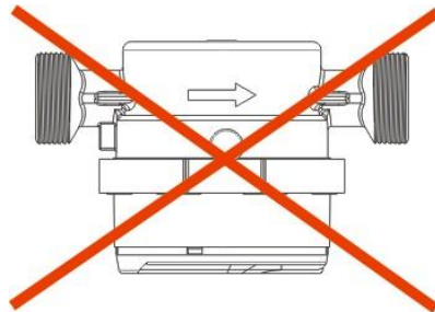
Figura 2. Formas prohibidas de montar los medidores de agua producidos por Apator Powogaz
