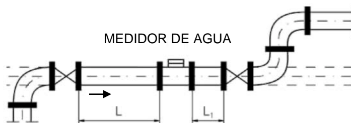
Figura 4. Instalación del medidor de agua.
