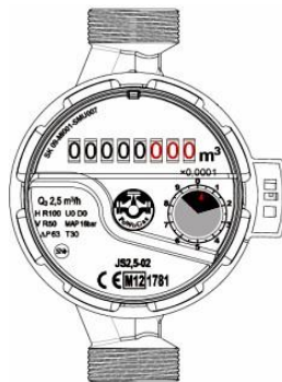
Figura 3. Posición recomendada del mecanismo de conteo durante el montaje vertical
